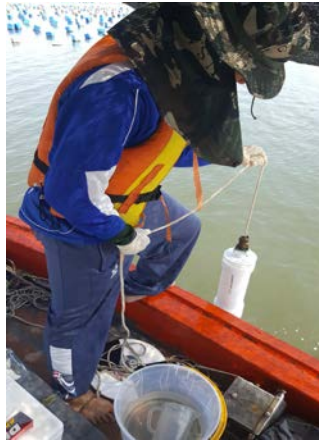
รูปที่ 4 การใช้ Water Sampler เก็บตัวอย่างน้ำทะเล
